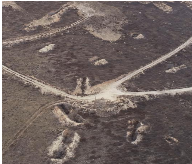
照片 1-12 探槽（部分）
